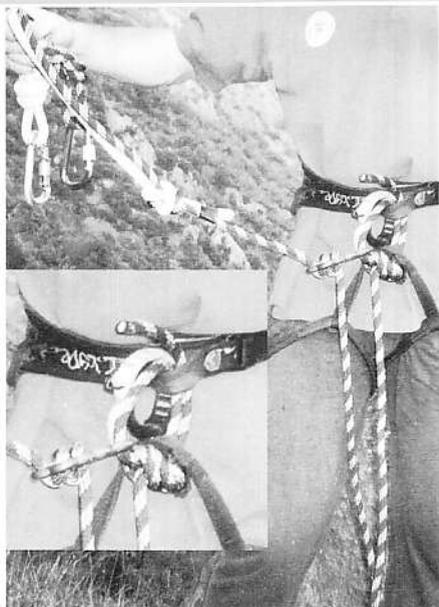
Collegamento del dissipatore all'imbracatura
